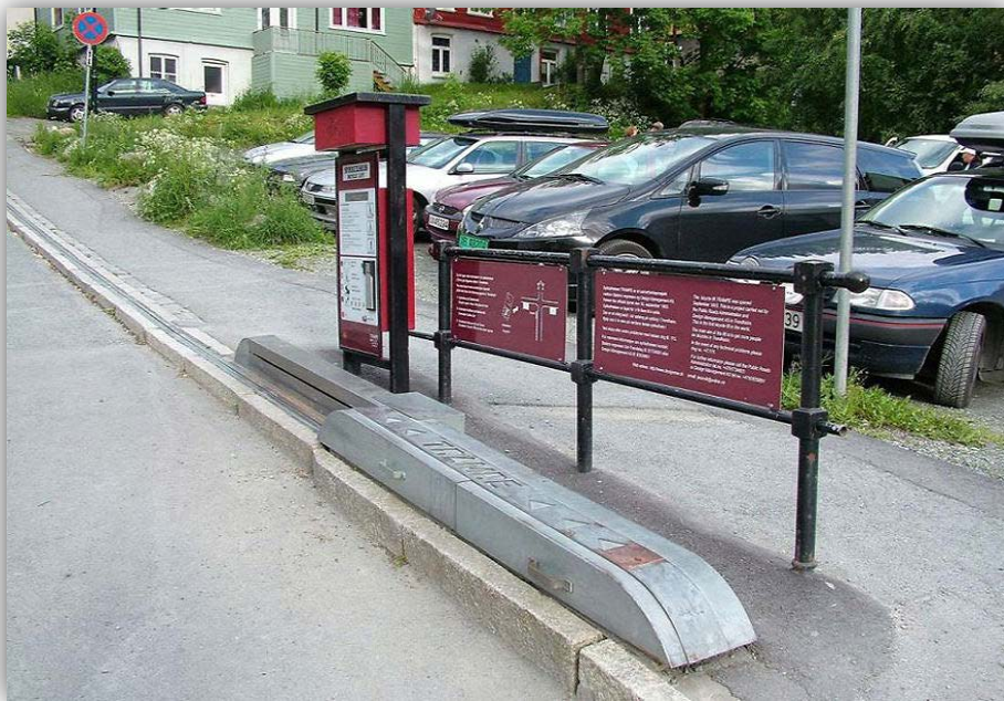
(圖1)單車電梯(CycloCable)
